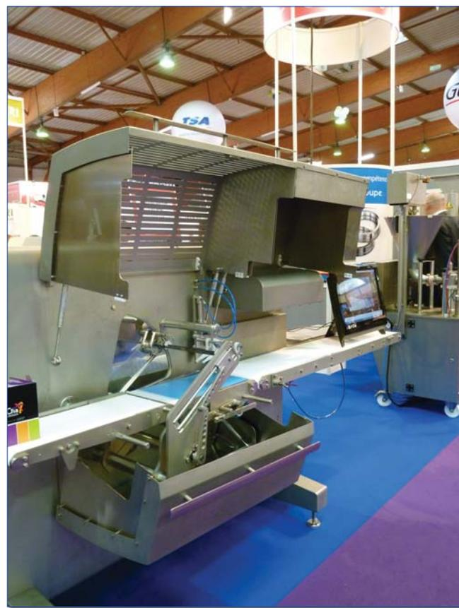
Grâce à un scanner 3D, la trancheuse islice de Lassoudry découpe des tranches de poids toujours identiques.
