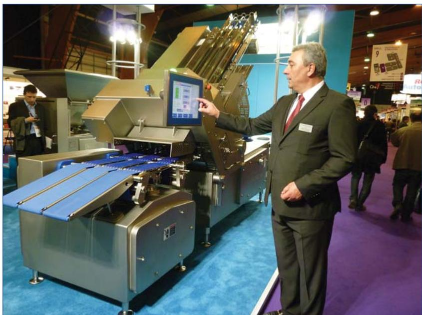
**L'interface homme-machine de la trancheuse Powermax 3000 de Formax a été développée en interne. Un PC industriel pilote la machine.**
