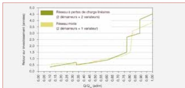
Figure 2 : Temps de retour sur investissement estimé pour 2 installations constituées de pompes en parallèle et des 2 solutions de commande.
