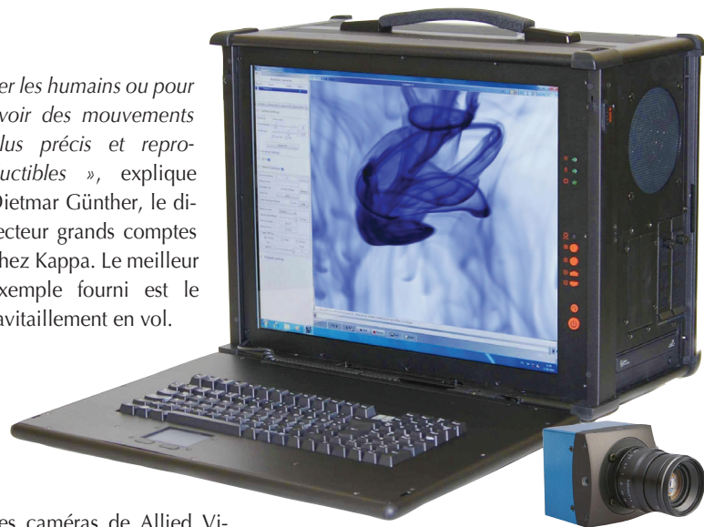
Le MotionBlitz LTR1 portable de Mikrotron est un enregistreur vidéo mobile pour les prises de vue longue durée jusqu'à 110 minutes.
