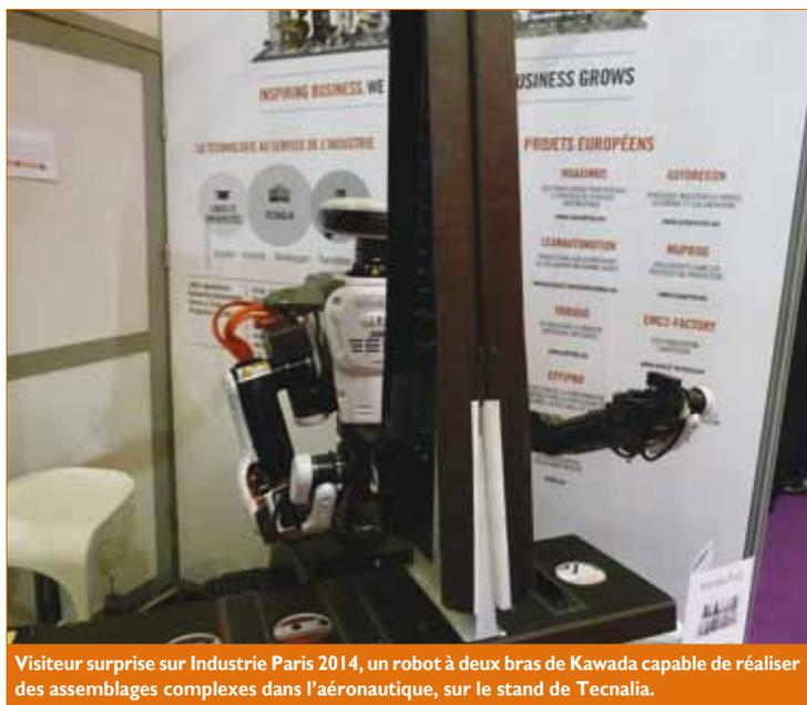
Visiteur surprise sur Industrie Paris 2014, un robot à deux bras de Kawada capable de réaliser des assemblages complexes dans l'aéronautique, sur le stand de Tecnalía.
