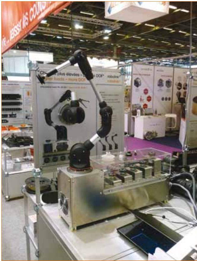
Igus arrive aussi sur le monde des robots avec les bras articulés MC Robots. Leur particularité ? Leurs mouvements sont réalisés grâce à des cordes très particulières.
