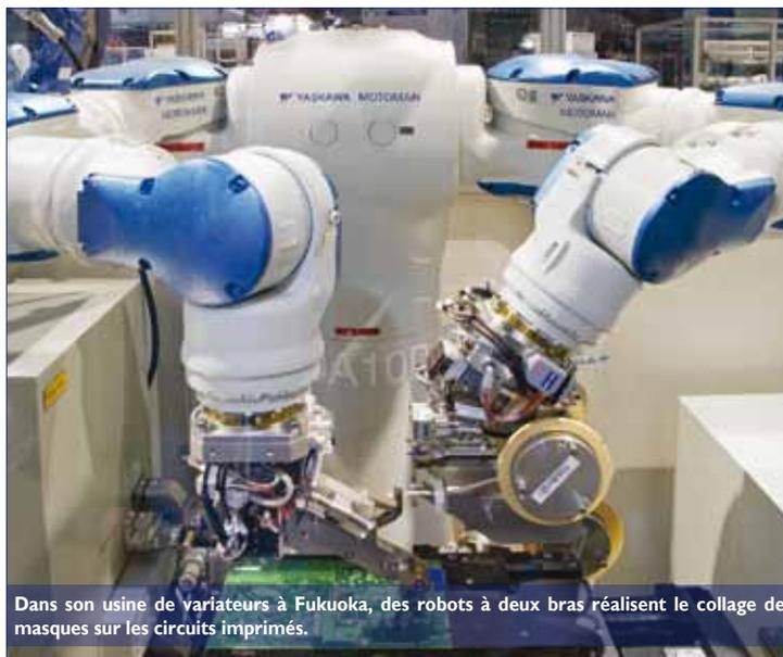
Dans son usine de variateurs à Fukuoka, des robots à deux bras réalisent le collage de masques sur les circuits imprimés.
