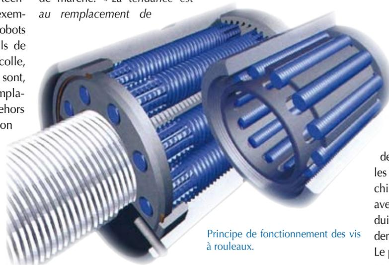
Principe de fonctionnement des vis à rouleaux.
