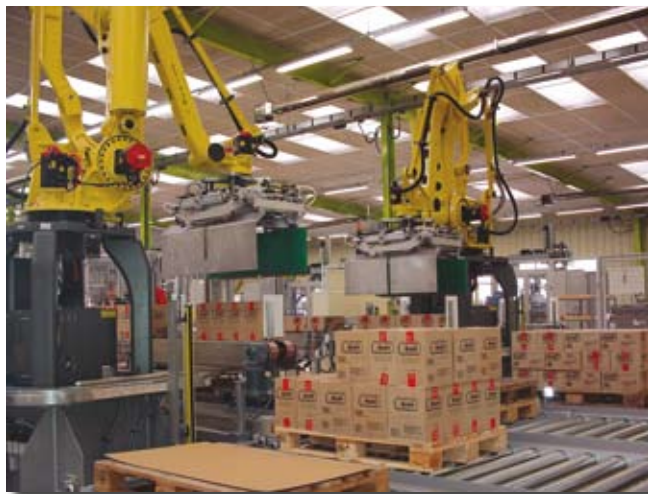
De nombreuses fonctions mécaniques et pneumatiques sont aujourd'hui remplacées par des servomoteurs. Ainsi, dans le secteur de l'emballage, la formeuse de caisses passe de plus en plus le relais au robot d'encaissage. (source Cermex)
