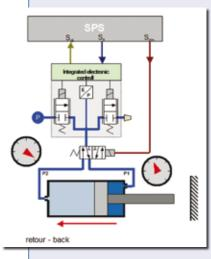
L'électrovanne proportionnelle permet d'optimiser les mouvements pneumatiques. Il est alors possible d'ajuster la force déployée par l'actionneur, de même que sa vitesse de déplacement. L'électrovanne proportionnelle donne aussi le choix d'une montée en pression progressive pour augmenter l'effort dynamique en position finale.
