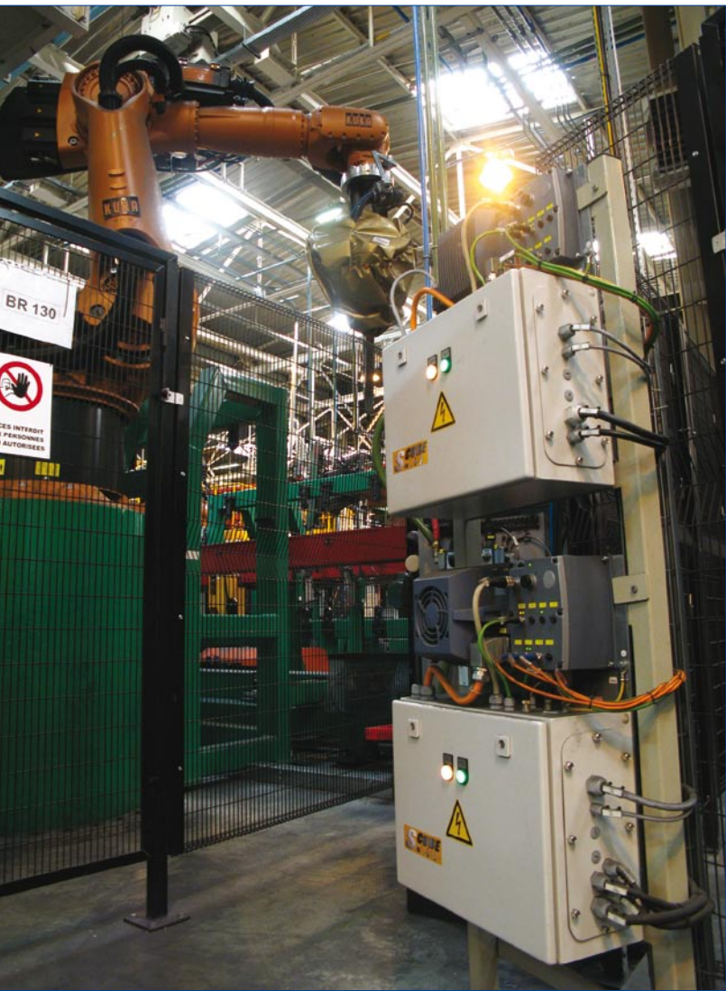
Scube comprend aussi des coffrets variateurs de vitesse (de 0,37 à 15 kW) pour les équipements de manutention standards, avec possibilité de freinage par réinjection de courant sur le réseau.
