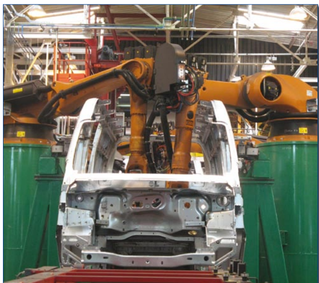
Avec ses 220 robots, la ligne de tôlerie du nouveau Master est capable d'assembler 350 variantes de caisses.
