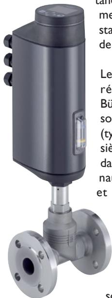
Les nouvelles vannes de régulation de process Bürkert sont disponibles soit avec un siège incliné (type 3360), soit avec un siège droit (type 3361), dans des diamètres nominaux compris entre 15 et 50. Supportant une pression de service maximale de 16 bars, elles peuvent être utilisées avec des gaz, des liquides et de la vapeur et sont conçues pour des températures de fluide comprises entre -10°C et +185°C.
