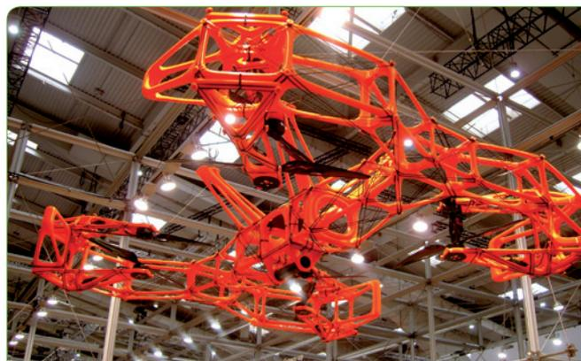
Un drone de la taille d'une confortable berline en cours d'impression dans l'espace consacré à la fabrication additive.
