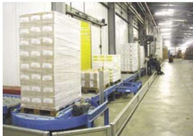
Convoyeur dirigeant les palettes vers le quai d'expédition.
