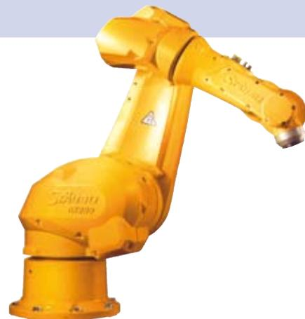
Dernière variante, le TX90HE, une version pour environnement humide avec un bras étanche en IP65, un poignet pour sa part en IP67. Existant en version TX40, 60 ou 90 ces robots ne craignent pas les liquides ou solvant couramment employés aussi bien dans l'agroalimentaire que dans les industries mécaniques avec les lubrifiants. Sur le stand d'Automatica, un robot TX version HE, plongeait inlassablement son poignet dans l'eau d'une piscine. ■
