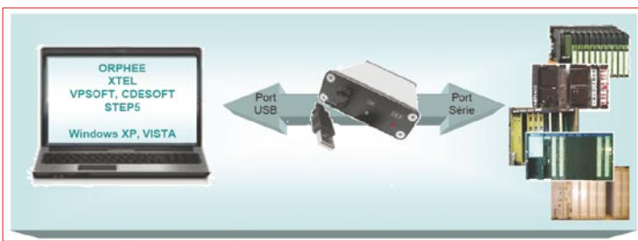
Solution basée sur une machine virtuelle et un boîtier assurant la synchronisation des vitesses, la gestion des time out.
