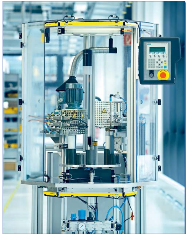
Les barrières Minitwin de Sick peuvent être placées en cascade, sans souffrir de zones mortes.
