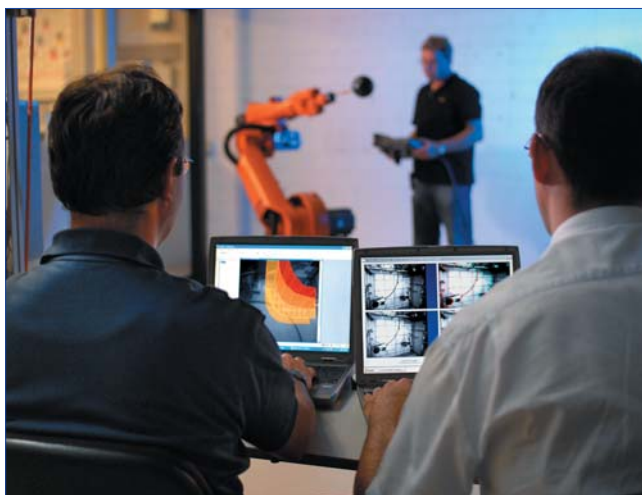
Le Safetyeye de Pilz permet de détecter la présence d'un opérateur dans des zones en trois dimensions et de modifier l'allure du robot en conséquence.
