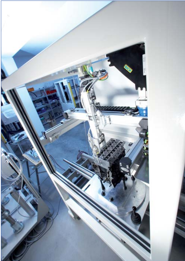
Placée dans le coin d'une ouverture, la caméra V300 WS de Sick y détecte les intrusions.
