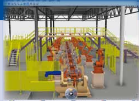
Delmia permet de simuler toute une ligne robotisée. Les outils d'Intercim font le lien avec la réalité.
