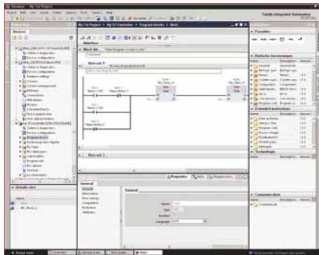
TIA Portal est constitué d'un environnement central et de deux volets : à gauche la liste des appareils, à droite les outils à disposition des utilisateurs.
