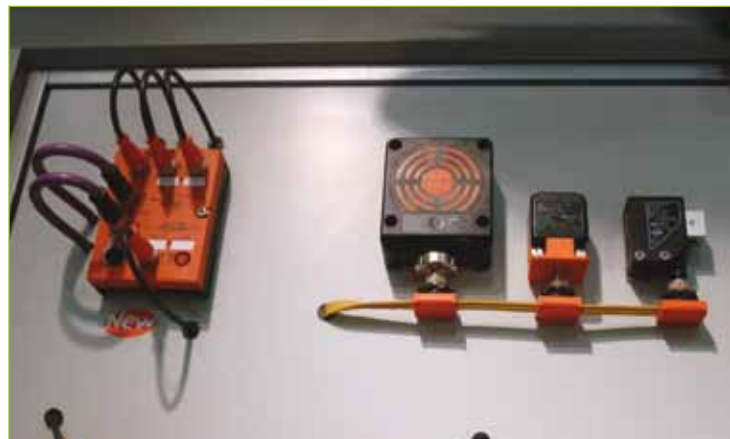
La borne DTE 100 d'IFM permet de connecter indifféremment des lecteurs de tags RFID basse ou haute fréquence.
