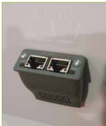
Scoop : un Anybus-CC compatible Ethernet Powerlink. Il fallait avoir la vue très fine pour le dénicher sur le stand de l'EPSSG.
