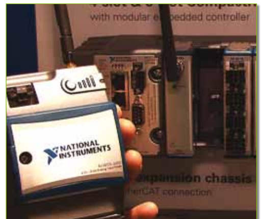
Avec le module NI 9795, désormais, National Instruments propose des passerelles de communication sans fil directement enfichables dans les contrôleurs CompactRIO.
