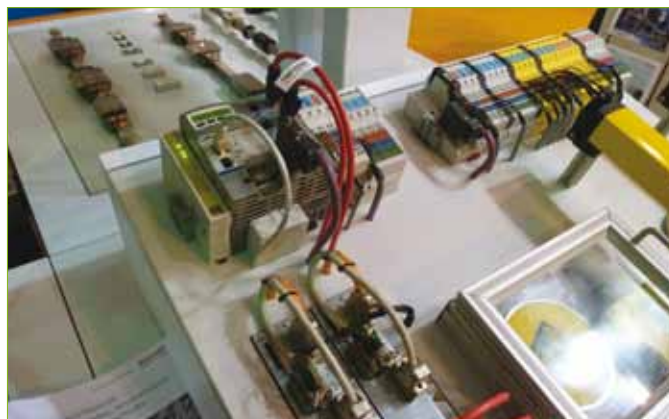
Bosch Rexroth propose d'ajouter de la sécurité sur une architecture classique en associant un processeur dédié à la sécurité à l'automate de la machine.
