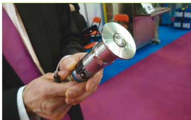
Dans une canalisation, le détecteur de niveau Liquipoint FTW 33 d'Endress+Hauser ne dépasse que de 1 à 2 mm, pour ne pas gêner les râcleurs.
