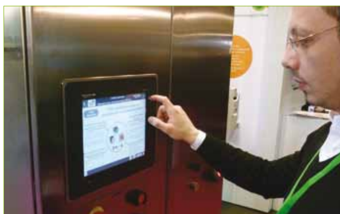
Pour séduire le monde de l'agroalimentaire, Schneider Electric a développé des versions tout en inox de ses IHM Magelis.
