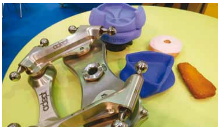
Adept Technology élargit sa gamme de produits avec des préhenseurs en silicone actionnés par le vide, qui peuvent prendre des donuts ou des produits panés.
