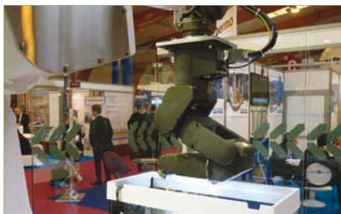
Cette version du petit robot LR Mate de Fanuc inaugure un nouveau traitement qui résiste aux produits détergents les plus agressifs.
