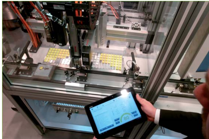
Cette machine de démonstration de Bosch Rexroth est composée de quatre postes indépendants pilotés par la RFID et une... tablette !
