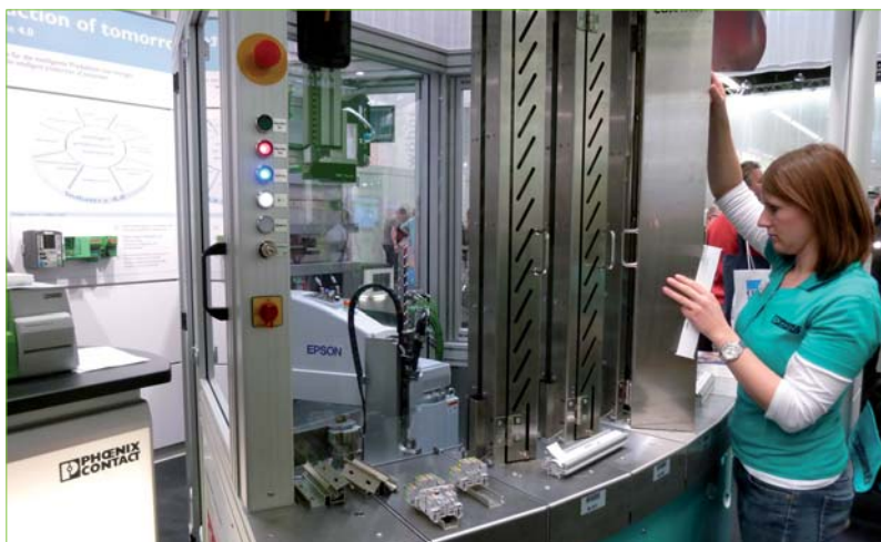
Cette machine de Phoenix Contact monte des boîtiers de jonction directement à partir de consignes données en conception.
